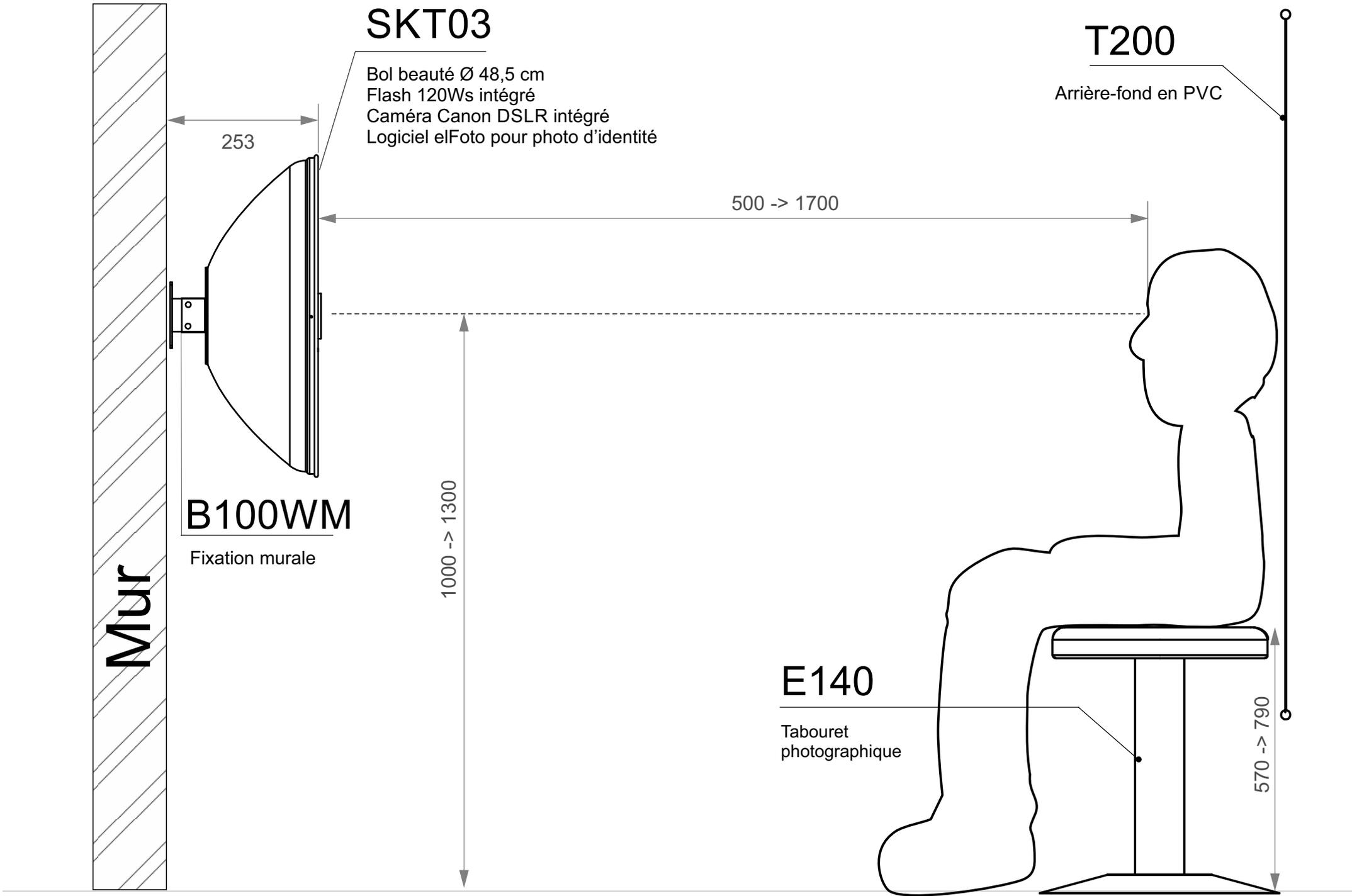
Exemple de disposition : Système Photo d'identité pour montage mural
